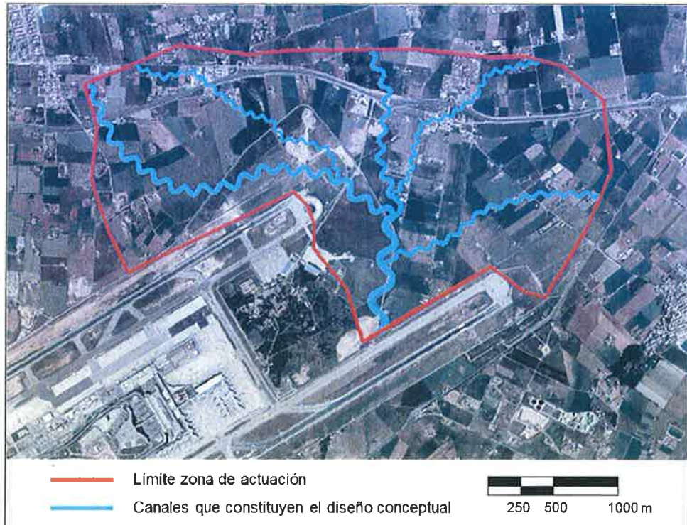
Figura 69. Diseño conceptual de la red de drenaje obtenida mediante la aplicación Natural Regrade.
